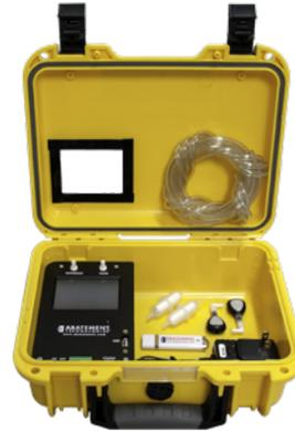
Le moniteur de pression portable PPM3-S d'Abatement Technologies® est un outil essentiel pour mesurer le différentiel de pression en temps réel entre deux endroits adjacents au sein d'une installation.
