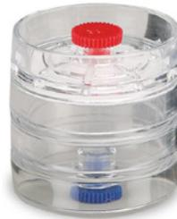
Cette cassette MCE de 37 mm est un mélange de cellulose ester mixte de 0,8 µm et est spécialement conçue pour l'échantillonnage du plomb. 50 par boîte. Les cassettes sont conçues et fabriquées pour répondre à toutes les normes NIOSH / EPA / OSHA applicables pour le prélèvement de plomb. Chaque cassette est assemblée individuellement, pré-chargée, testée pour le débit et marquée selon des procédures d'assurance qualité strictes.
